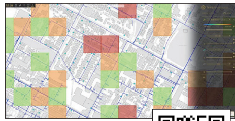
↑天地人コンパス宇宙水道局のイメージ：衛星データと水道管情報などを組み合わせてAIで解析することにより、水道管の漏水リスクを予測する。
